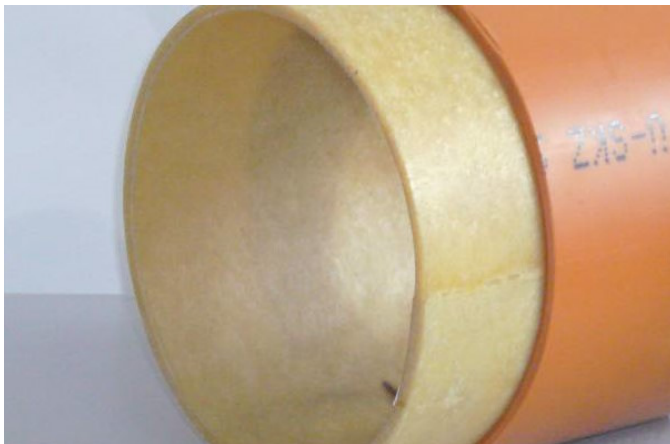
Abb.: Egal ob ein kleiner Schaden mit einem Kurzliner oder die ganze Leitung mit einem Schlauchliner saniert wird, es entsteht immer ein Rohr im Rohr
