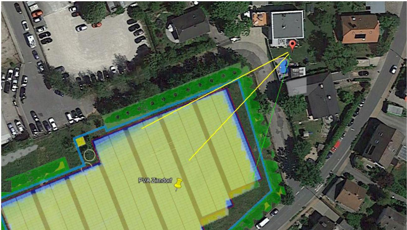
Bild 4.1.2: Reflexionen am Messpunkt P1 (Quelle: Google Earth / SolPEG)
